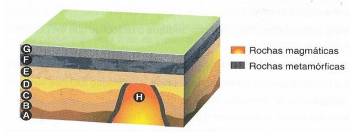
Na região depositaram-se, em primeiro lugar, os estratos A, B, C e D. Depois, instalou-se a intrusão magmática, H. Após a intrusão magmática, os estratos sofreram erosão. Finalmente, depositaram-se os estratos E, F e G.
